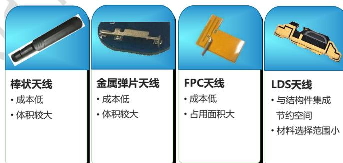
图 4- 7 NB-IoT常规天线类型推荐
